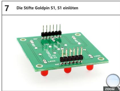
**!** Beginnen Sie mit dem Zusammenbau, indem Sie die Bauteile in der Reihenfolge von der kleinsten zur größten Größe auf die Platine löten. Achten Sie beim Einbau von Bauteilen, die mit einem Ausrufezeichen gekennzeichnet sind, auf deren Polarität.
