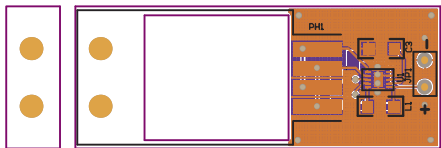
Rysunek 2. Schemat montażowy konwertera drgań mechanicznych
