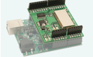
AVTduino ETHERNET - Moduł Ethernet dla Arduino AVT1668
