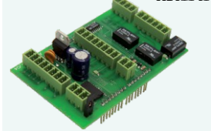
PICduino - płytki bazowa z PIC18F2550 AVT1625
