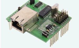
AVTduino RS - Moduł interfejsów szeregowych AVT5351
