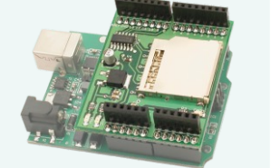
AVTduino PWM - Uniwersalny moduł dla Arduino AVT1677
