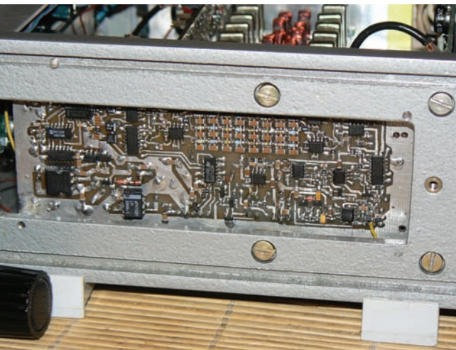
Widok na zasadniczy trakt transceivera Pilgrim (płytkę odwzorowaną własnoręcznie)
