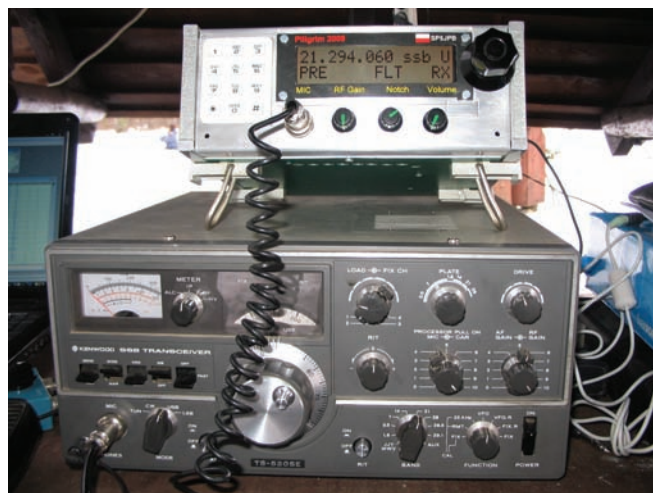
Transceiver Pilgrim SMD zdecydowanie przewyższa parametrami lampowy Kenwood TS520 (poza mocą wyjściową nadajnika)
