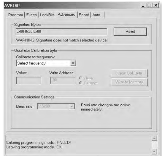
Rys. 8. Zakładka „Advanced” umożliwiająca sprawdzanie sygnatur mikrokontrolera
