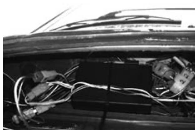
Fot. 2. Układ wmontowany i połączony z instalacją samochodu
