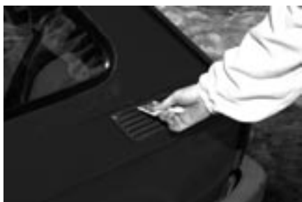
Fot. 4. Gniazdo kart wmontowane w plastikową atrapę wlotu powietrza (Fiat 126p)
