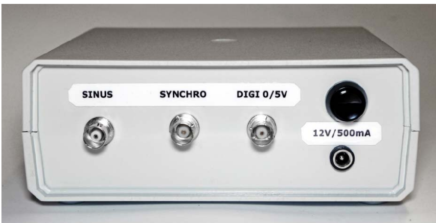
Fotografia 16. Przykładowe wykonanie i opis tylnego panelu generatora
