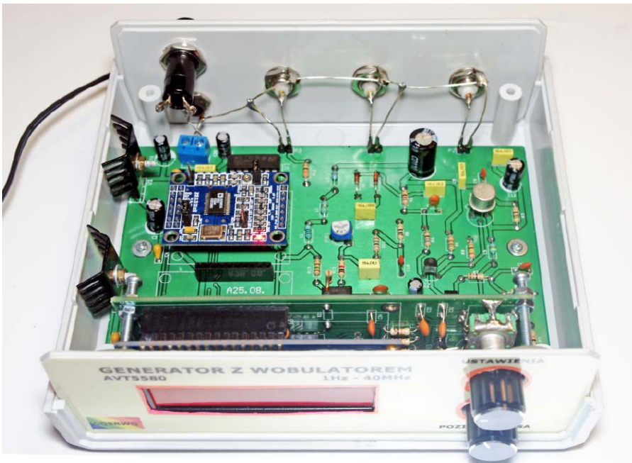
Fotografia 14. Widok zmontowanego generatora od przodu
