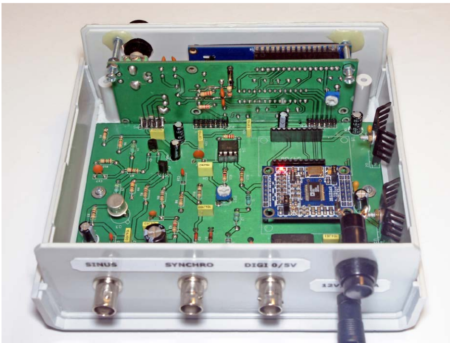
Fotografia 15. Widok zmontowanego generatora od tyłu
