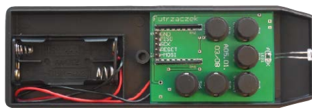
Fotografia 13. Wnętrze pilota zdalnego sterowania
