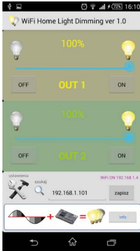
Rysunek 8. Okno główne aplikacji regulatora oświetlenia
