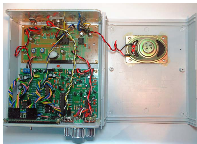
Fotografia 8. Montaż odbiornika Lidia-80 DIGITAL w obudowie Kradex Z2
