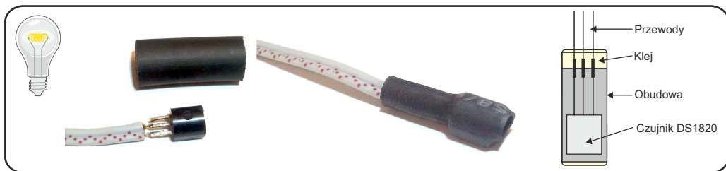
Przykład zabezpieczenia czujnika
