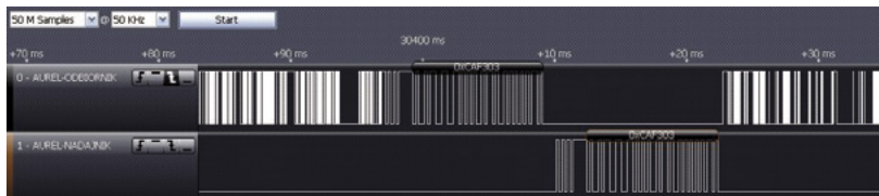
Rysunek 2. Rzeczywiste przebiegi sygnałów sterujących po stronie układu Slave dla rozkazu ustawienia nowego poziomu jasności (rozkaz 0b0011).
