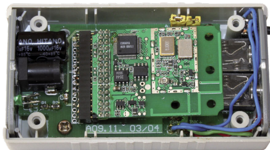
Fotografia 8. Płytkę odbiornika zamontowaną w obudowie. Moduł odbiornika zamontowany jest równoległo do płyty bazowej
