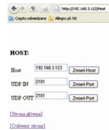
Rysunek 16. Ustawienie parametrów HOST dla konwertera nr 1
