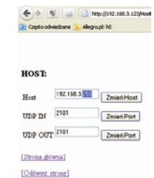
Rysunek 20. Uzupelnienie adresu broadcast dla konwertera nr 1
