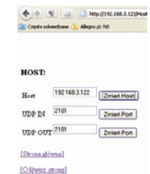
Rysunek 18. Ustawienie parametrów HOST dla konwertera nr 2
