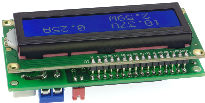
Rys. 3 Sposób montażu wyświetlacza
