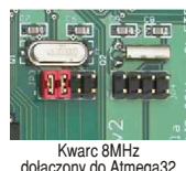
Kwarc 8MHz dołączony do Atmega32
