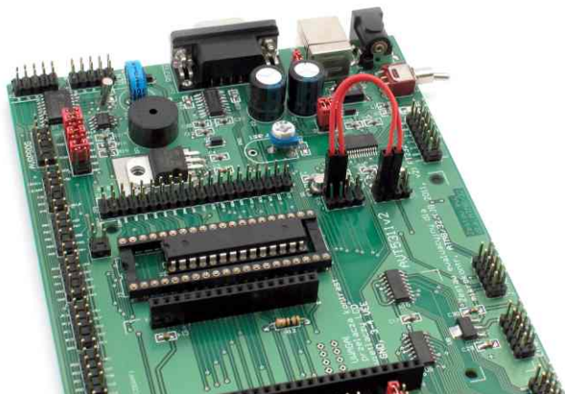
Sposób dołączenia rezonatora 8MHz do mikrokontrolera ATmega8
