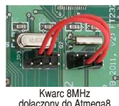
Kwarc 8MHz dołączony do Atmega8
