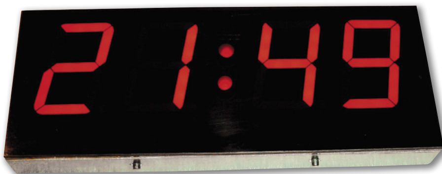
Fotografia 1. Pierwszy prototyp zegara w wersji 4-cyfrowej
