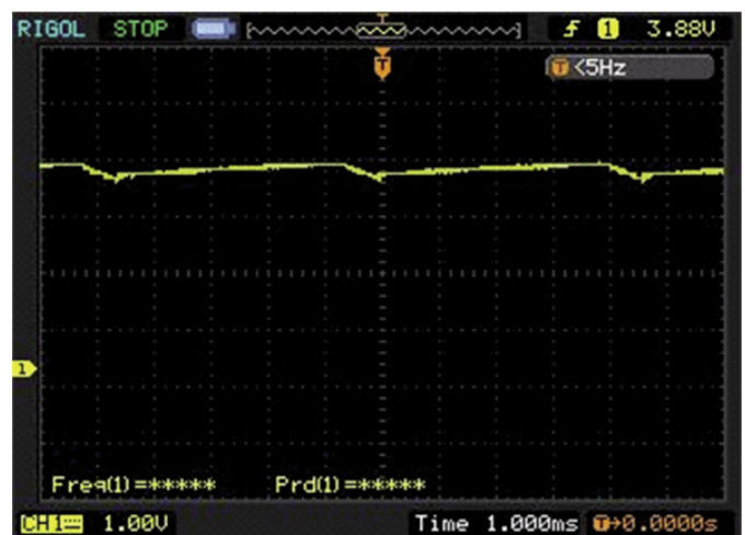
Rysunek 5. Spadki napięcia zasilania modułu GSM w przypadku użycia kondensatorów tantalowych o łącznej pojemności 2900 \mu F
