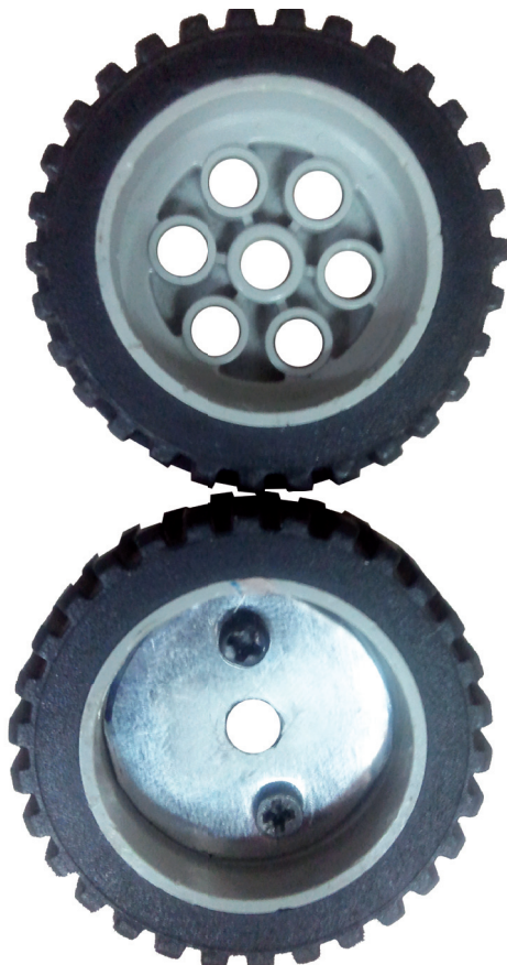
Fotografia 3. Modyfikacja kół w celu ich zamocowania na serwomechanizmie
