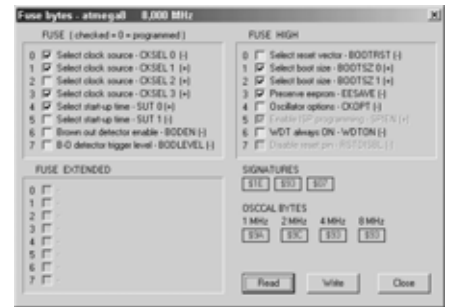
Rys. 4. Okno dialogowe konfiguracji po odczycie bitów fuse
