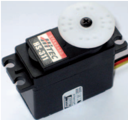
Fot. 1. Wygląd typowego serwomechanizmu przed wykonaniem modyfikacji
