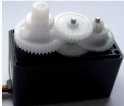
Fot. 4. Przekładnia serwomechanizmu przed wykonaniem modyfikacji
