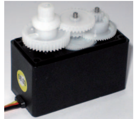
Fot. 5. Przekładnia serwomechanizmu po usunięciu występu blokady maksymalnego wychylenia osi
