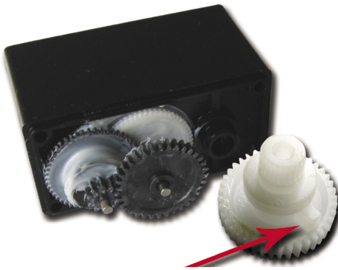
Fot. 3. Przeróbka serwo mechanizmu – usunięcie blokady na zębatce
