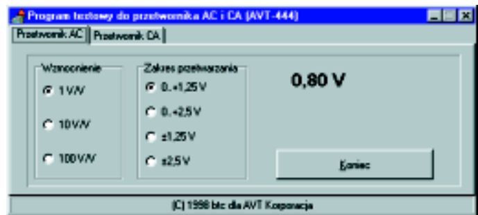
Rys. 11. Wygląd ekranu programu testowego 444_TEST - zakładka przetwornika AC.
