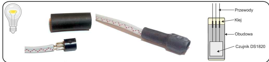
Przykład zabezpieczenia czujnika
