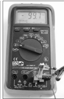
Fot. 4 Pomiar indukcyjności dławika 10μH
