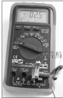
Fot. 2 Ta sama cewka (jak na fotografii 2) po rozciągnięciu zwojów daje indukcyjność 0,25μH (dolna granica pomiaru indukcyjności; wartość może być obciążona znacznym błędem)
