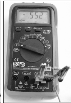
Fot. 6 Pomiar indukcyjności dławika 56μH (górna granica pomiaru indukcyjności; wartość może być obciążona znacznym błędem)
