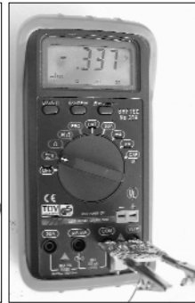
Fot. 5 Pomiar indukcyjności dławika 33μH
