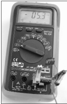
Fot. 1 Pomiar indukcyjności cewki 0,5μH (12 zwojów DNE 0,5 na średnicy 6mm; zwoje ściśnięte)
