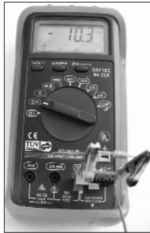
Fot. 3 Pomiar indukcyjności dławika 10μH
