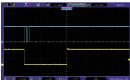
Rysunek 2. Przebiegi napięcia: na zaciskach czujnika drgań (niebieski) i na wyjściu układu (żółty)
